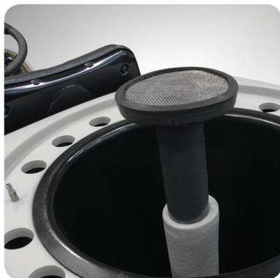
El sistema anti-espuma reduce drásticamente la formación de espuma protegiendo el motor de aspiración y el interruptor electrónico de flotador interrumpe la aspiración cuando el depósito está lleno. La amplia apertura del depósito permite una limpieza eficiente, rápida y completa. La resistente boquilla de secado
