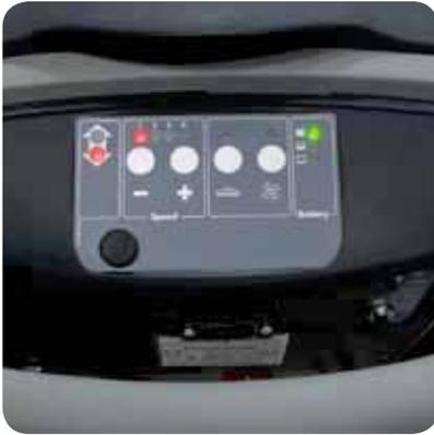
Panel de control analógico, fácil e intuitivo. Regulador velocidad de avance. Interruptor general de llave, interruptor motor cepillo y motor de aspiración. Disyuntor térmico para proteger motor cepillo y motor de aspiración, indicador de nivel de batería, contador de horas de trabajo
