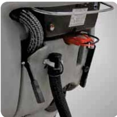
Resistente plato cepillos en acero de 15 mm. Gran presión sobre el suelo para una limpieza profunda incluso la suciedad resistente. Sistema de auto nivelación. Electroválvula para interrumpir el flujo del detergente durante las interrupciones de trabajo.
