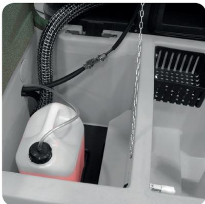
Sistema de levantamiento automático del cepillo (solo modelo 66BTA). Dosificación de detergente automático. Acceso rápido al depósito de recuperación, fácil de inspeccionar. Mantenimiento rápido y fácil de los componentes sin necesidad de herramientas. Soporte para el cambio rápido y
