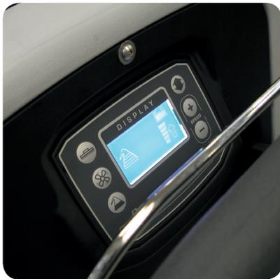
Panel de control digital es fácil y intuitiva. Palanca de transmisión del cepillo y la solución de distribución de la limpieza. Interruptor ON / OFF y interruptor a llave para la exclusión de la batería, interruptor motor cepillos y motor de aspiración, sistema automático de dosificación de los productos químicos. Disyuntor térmico para proteger motor cepillo y motor de aspiración, indicador de nivel de batería.
