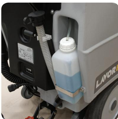
con caudal regulable. Depósito agua de recuperación con inspección visual. Extremadamente silencioso (62 dB) debido a la especial posición del motor de aspiración y el uso de materiales de aislamiento acústico. Gracias al soporte especial de la boquilla de secado es posible la
